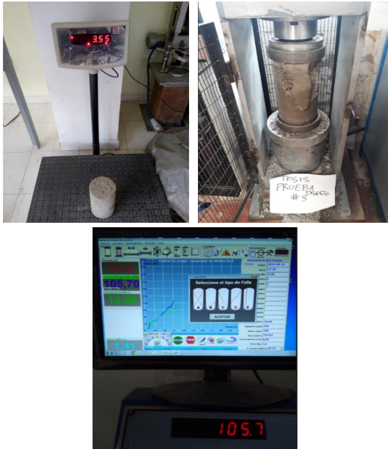
Figura 9 Proceso de rotura de cilindros a compresión.
