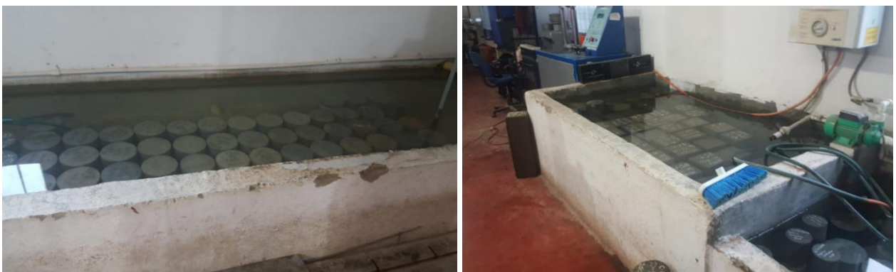
Figura 8 Proceso de curado de especímenes de concreto.
