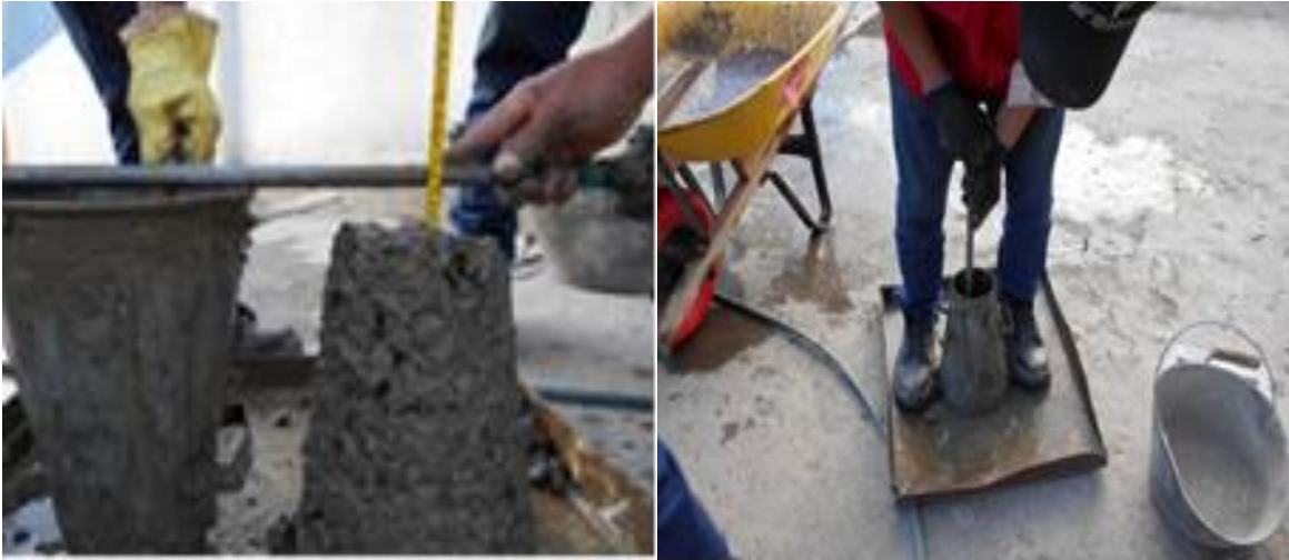
Figura 5 Ensayo slump a mezclas de concreto fresco con agregado reciclado.
