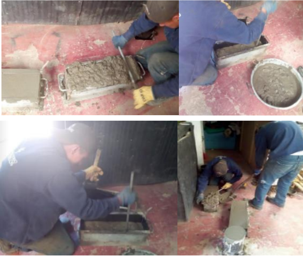
Figura 7 Elaboración de especímenes de concreto en forma de vigas.
