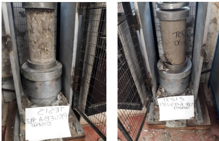
Figura 11 Falla por desprendimiento de material de cilindros. Edades entre los 7 y 14 días
