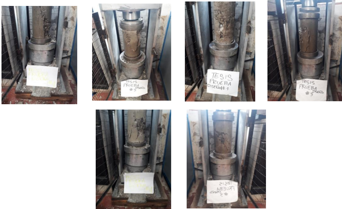
Figura 13 Falla tipo cono y grietas verticales. Ensayo a la edad de 28 días.
