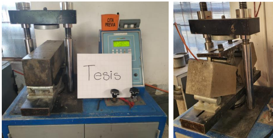
Figura 10 Proceso de rotura de vigas a flexión.
