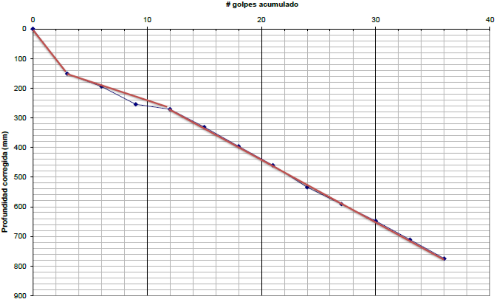
GRAFICA DE LA EVOLUCION DE LA PENETRACION ENSAYO DE PENETROMETRO DINAMICO DE CONO E-3
