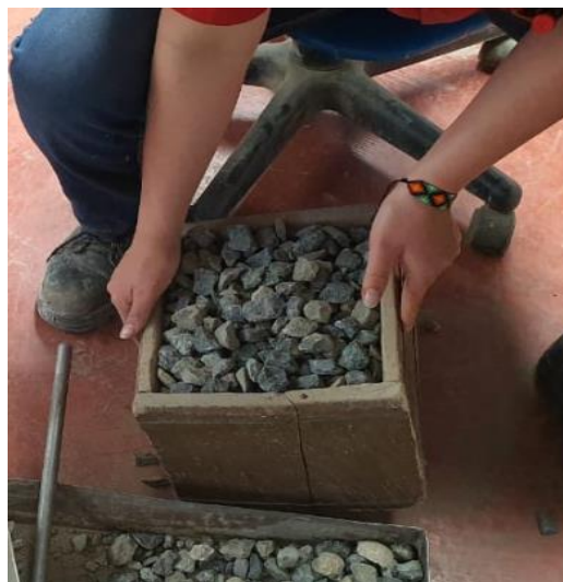
Figura 4 Dosificación de materiales en laboratorio para elaboración de mezclas.
