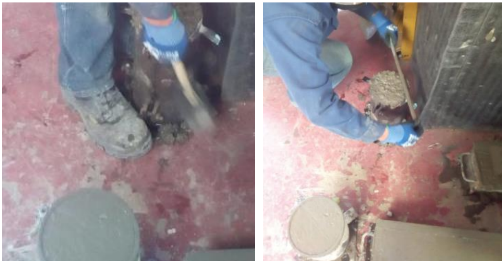
Figura 6 Elaboración de especímenes cilíndricos de concreto.
