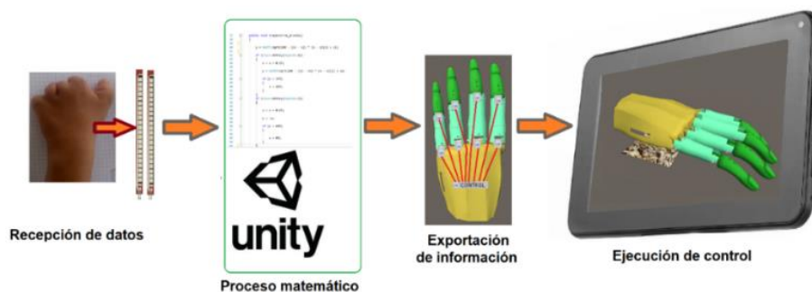
Figura 2-27 Estructura base para algoritmo de control.
