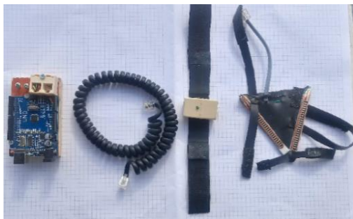
Figura 2-18 Dispositivo hardware para registro de datos (guante).
