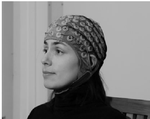
Figura 2.1: Distribución de sensores para EEG. Imagen tomada de [17].
