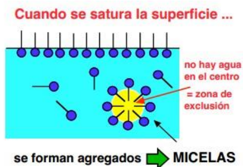
Figura 2.10 Formación de un agregado de moléculas de surfactante o Micela en el agua. (28)
