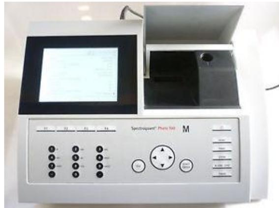
**Fig.8:** Espectrofotómetro spectroquant.
