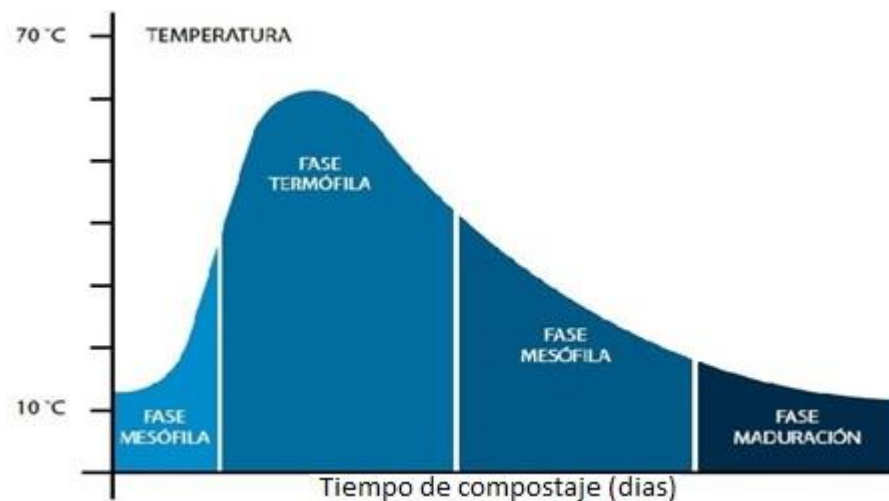
Figura 2. Fases térmicas del proceso de compostaje
