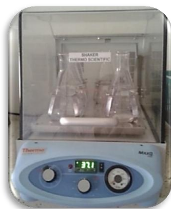
Figura A3.1. Shaker, equipo con agitación constante y control de temperatura.
