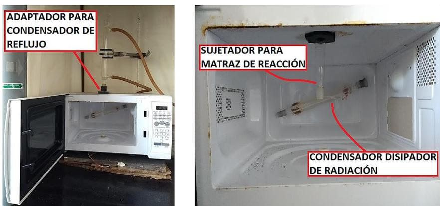
**Figura 8.** Equipo de microondas doméstico modificado utilizado en la investigación.
