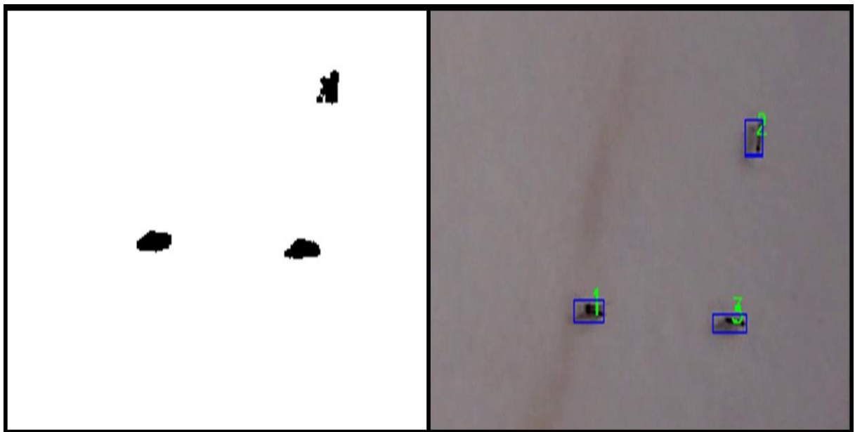
Figura 30: Izquierda: Segmentación aplicando operaciones morfológicas. Derecha: Tracking correcto.
