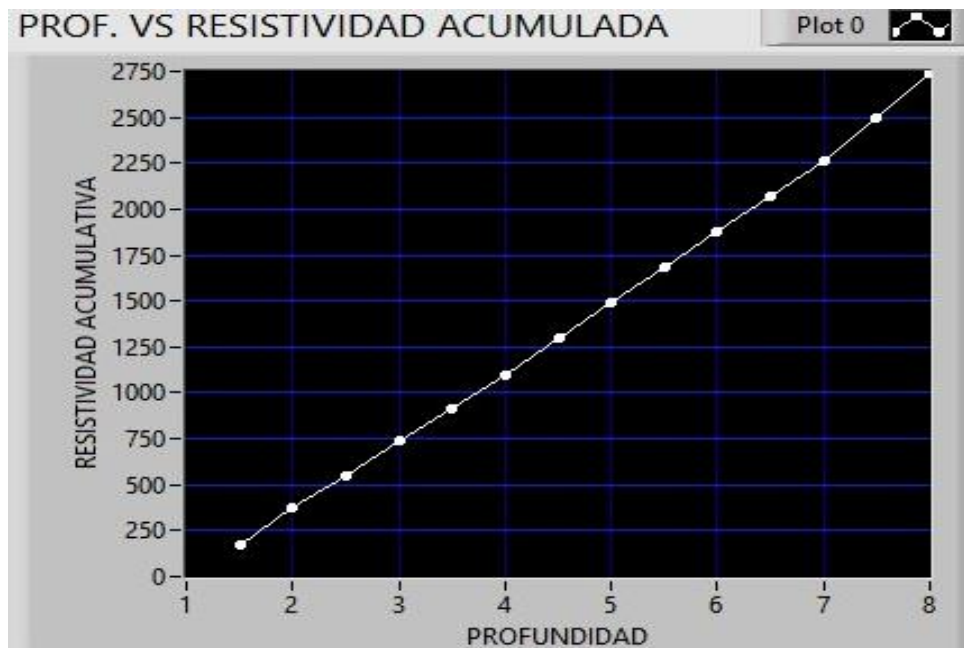
Figura 52 Curva de resistividad acumulada vs profundidad
