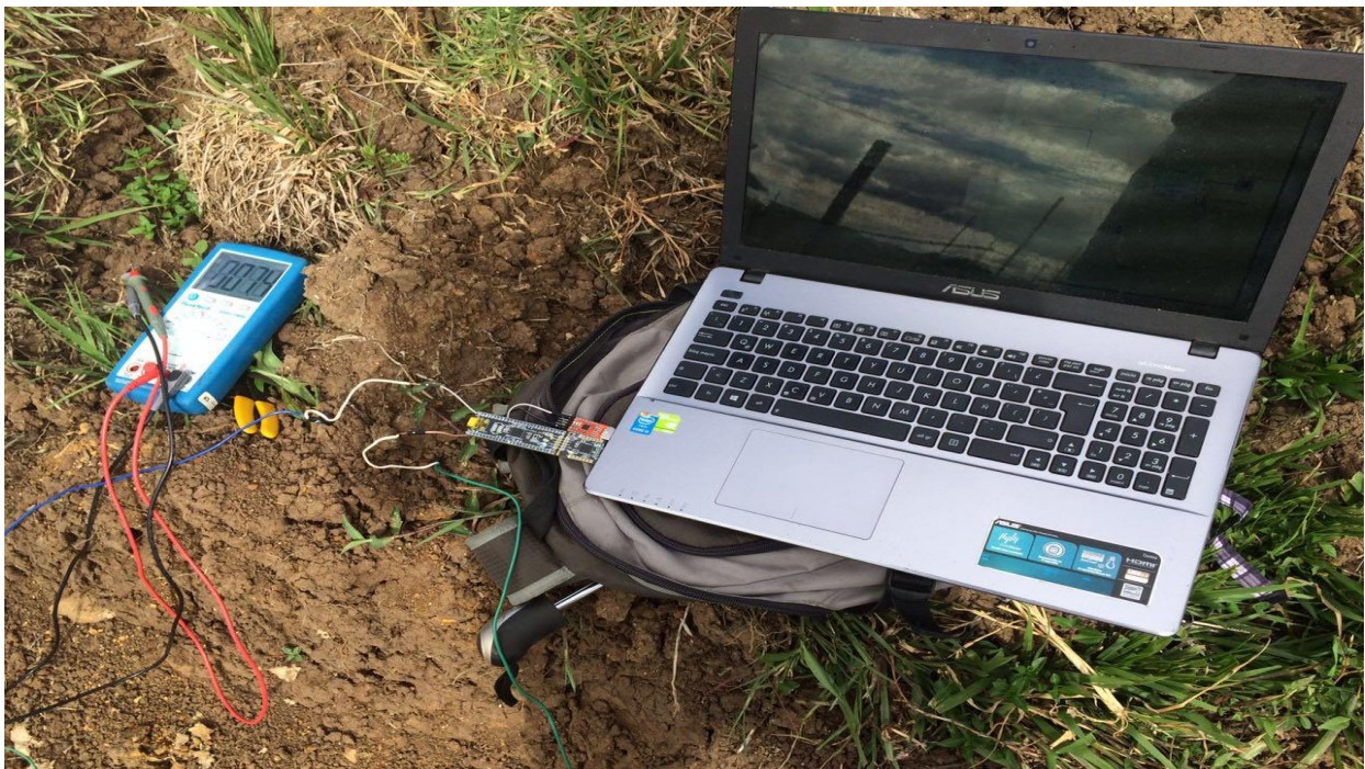
Figura 40. Fotografía de montaje utilizado para medición de diferencia de voltaje (Agosto 2016)
