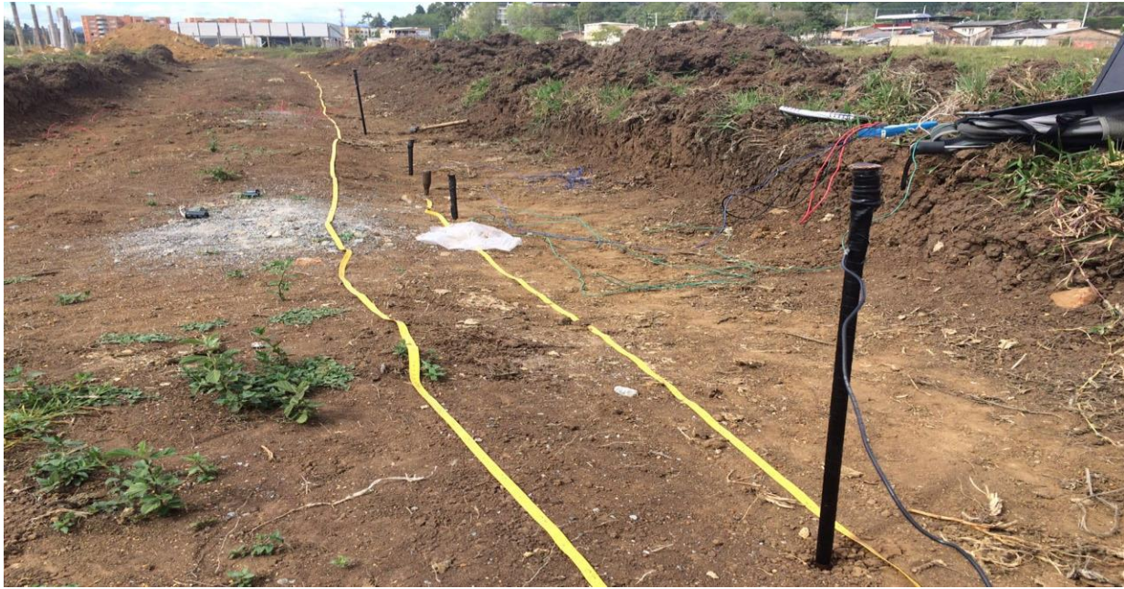
Figura 39. Fotografía de disposición y alineación de electrodos (Agosto 2016)
