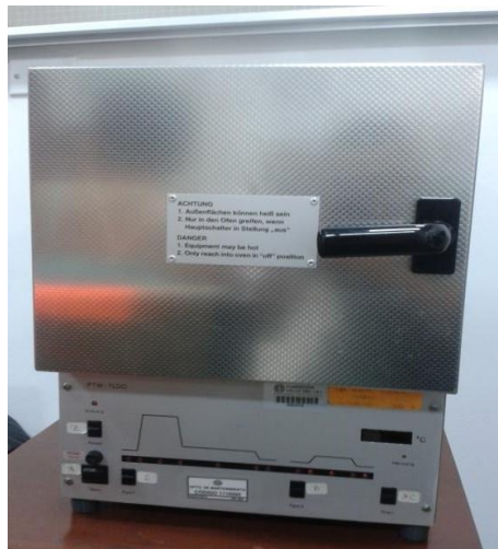
Figura 3.4. (Izquierda) Horno programable ubicado en la FVL. (Derecha) Perfil de temperaturas del ciclo de borrado para el TLD-100 en el horno programable, desde temperatura ambiente sube hasta 400 °C a razón de 20 °C/min en donde permanece una hora, luego baja a 100 °C donde permanece dos horas y por ultimo regresa a temperatura ambiente. (Foto tomada del equipo ubicado en la fundación valle del lili).
