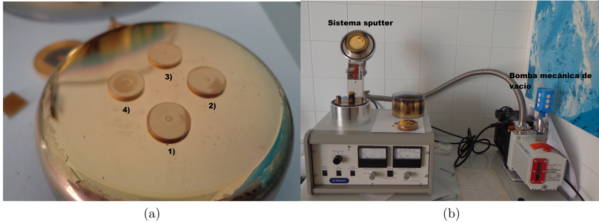
Figura 2.1: Proceso de electroado. (a) Sistema sputter cooter, con el que se hizo un recubrimiento de oro. (b) Pastillas de BLFO con recubrimiento en oro, con el fin de formar un capacitor de placas paralelas cilíndrico.
