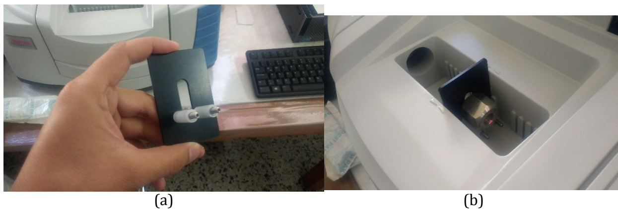
Figura 3.8 (a) Soporte para muestras en estado sólido (b) Soporte con muestra ubicado en compartimiento de muestras del FTIR.
