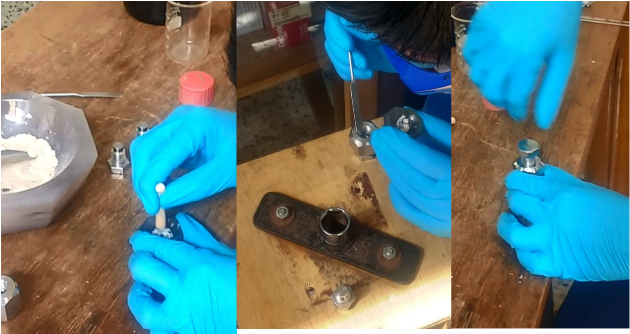
Figura 3.18 (a) Molienda de la muestra y KBr en morteros separados (b) Deposito de muestra/KBr en la prensa de pernos (c) Cierre del tambor con el perno superior
