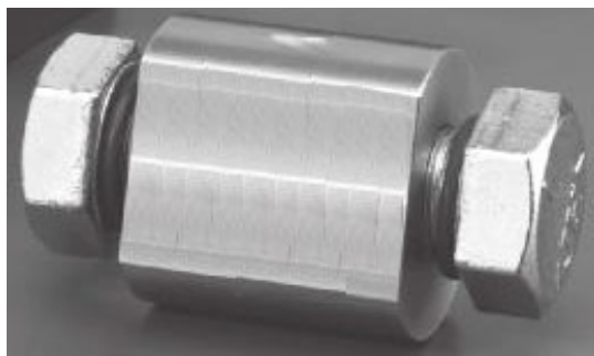
Figura 3.17 Prensa de pernos. Conformada por un tambor con rosca interna en el que se introducen dos pernos.
