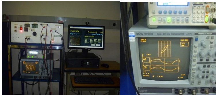
Imagen 16 sistema implementado para obtener las curvas de histéresis ferroeléctricas.
