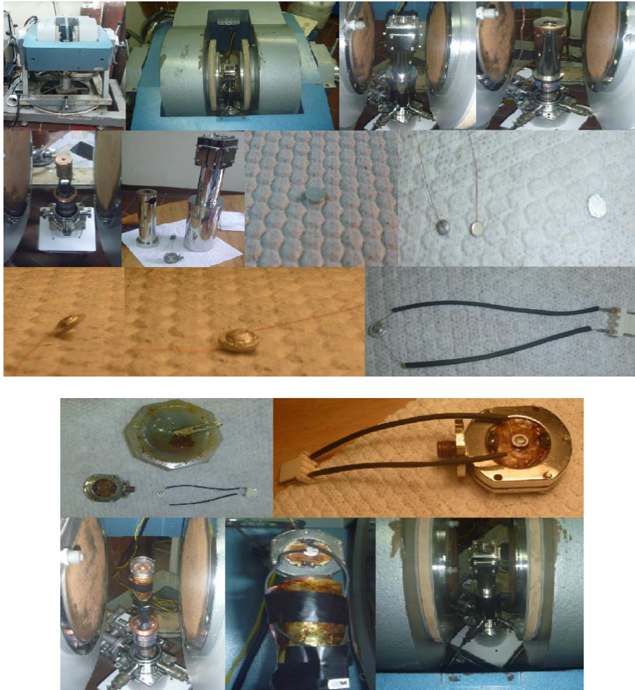
Imagen 17 pasos para el montaje de la muestra en el sistema criogénico.
