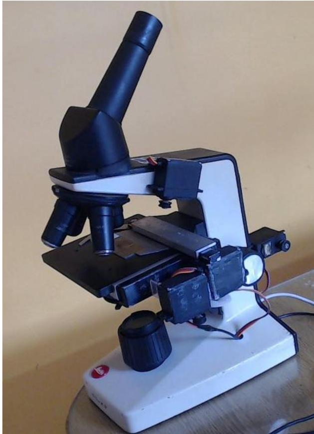
Figura 3. 11. Montaje de los motores paso a paso sobre el microscopio.
