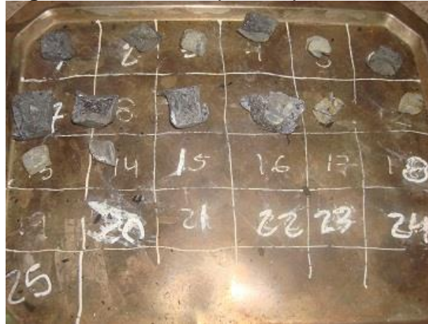
Figura 28. Muestras para copelación
