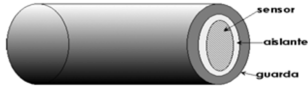
Figura 2.10. Configuración básica de un sensor capacitivo con anillo de guarda [4].
