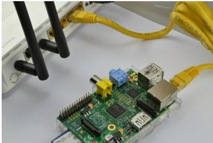
*Figura 38.* Conexión de la Raspberry Pi al Router Mediante Conexión Ethernet.
