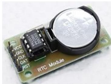
Figura 22. Módulo RTC. Módulo De Reloj de Tiempo Real.
