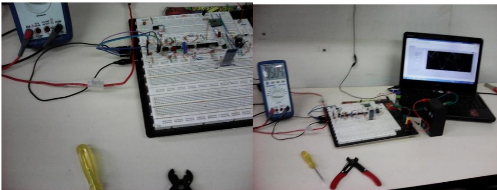
Figura 71. Montaje de medición de corriente mediante GMR en el conductor AW12
