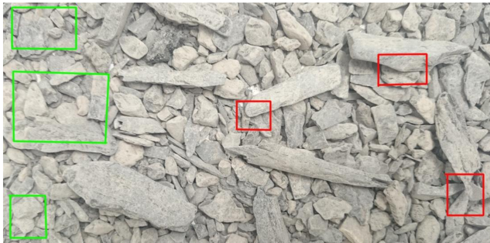
Figura 41. Errores en las imágenes de acumulaciones: mala definición de bordes (verde) y traslapamientos (rojo). Elaboración propia.
