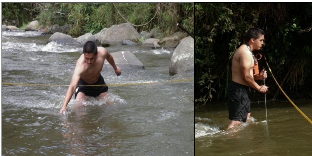
Imagen 5. Medición de caudal con flotador y molinete.
