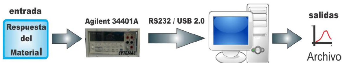
Figura 3. 16. Esquema del funcionamiento del equipo empleado para determinar la capacidad sensora de gases de un material. [27]
