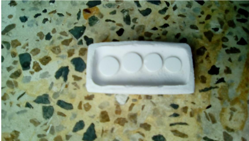
Figura 3. 9 Piezas cerámicas sinterizadas que contienen los polvos de ZTO.
