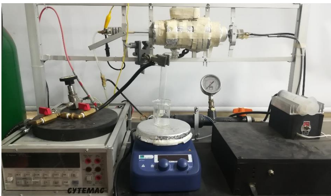
Figura 3. 23. Sistema para la evaporación y control de entrada de la acetona.
