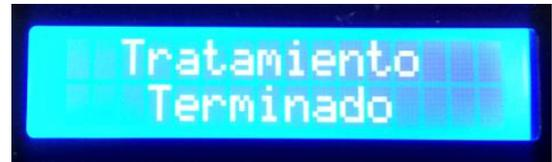
Terminado el tratamiento se volverá a desplegar el menú de selección del tipo de tratamiento. Para extraer el líquido tratado, apagar el sistema; empezando por elevador de voltaje seguido de la fuente variables y por último el sistema de control.
