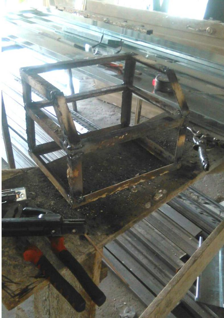
Figura B3.1. Soldado del armazón del sistema PEF [Fuente propia]
