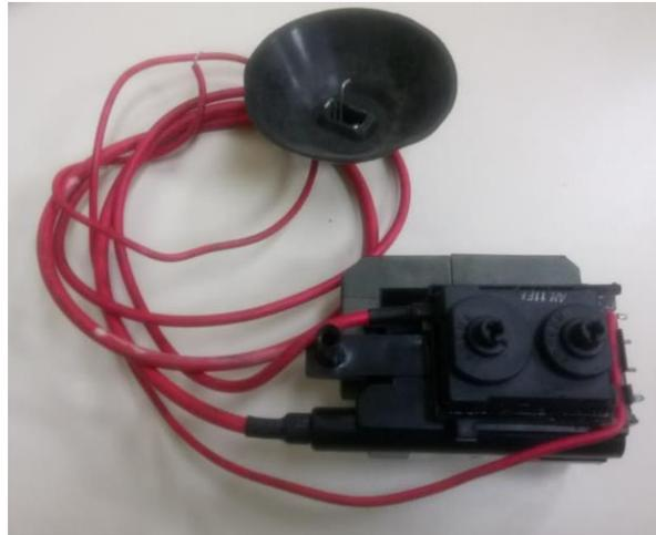
**Figura 3.3. Transformador Flyback [Fuente propia]**
