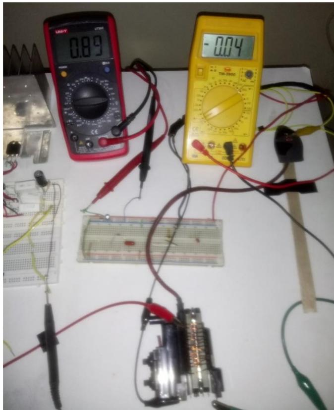
**Figura B2.4. Generador de alto voltaje [Fuente propia]**
