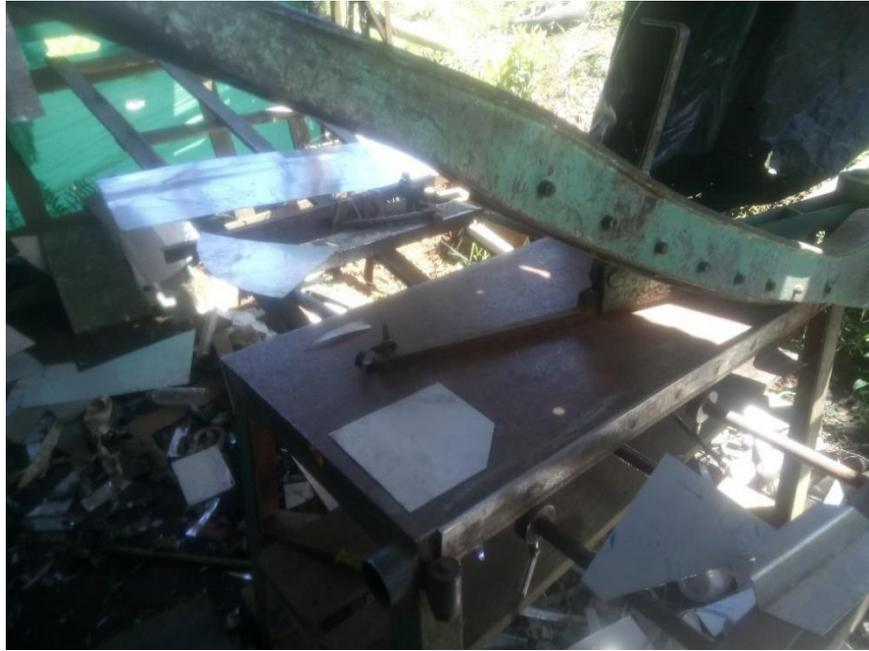
**Figura B3.2. Corte de láminas de acero inoxidable por cizalla [Fuente propia]**
