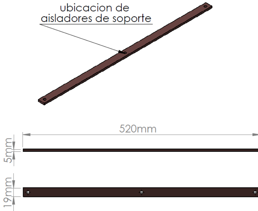
Figura 17. Barraje armario MC sistema AMI-SAA. (Fuente: elaboración propia)
