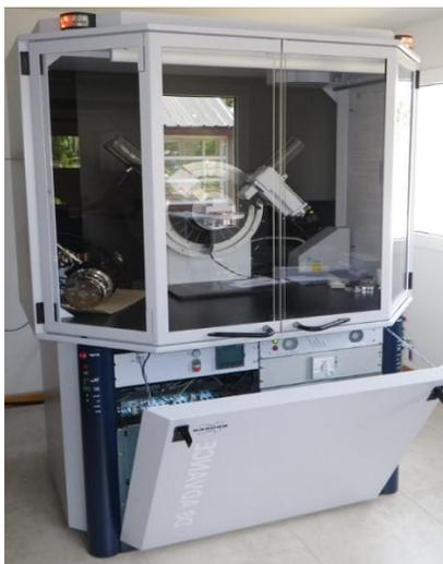
**Figura 2.5** Difractómetro de Rayos X Bruker D8 Advance
