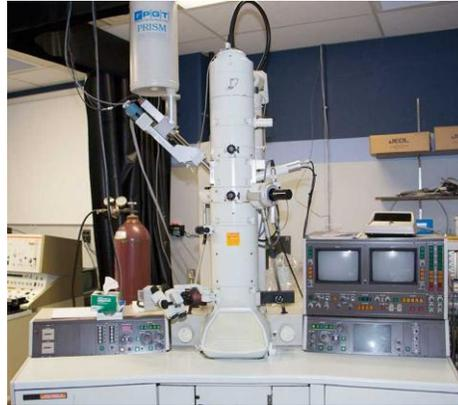
**Figura 2.6** microscopio electrónico de transmisión JEOL 1200-EX II
