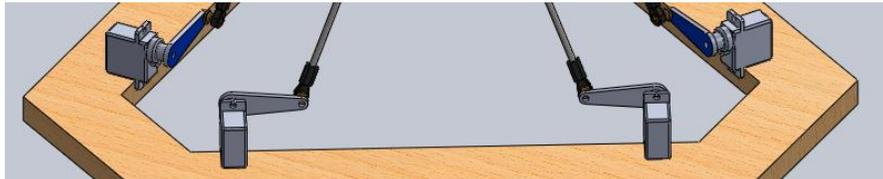
Figura 8.13. Orientación de Servomotores en el robot paralelo.
