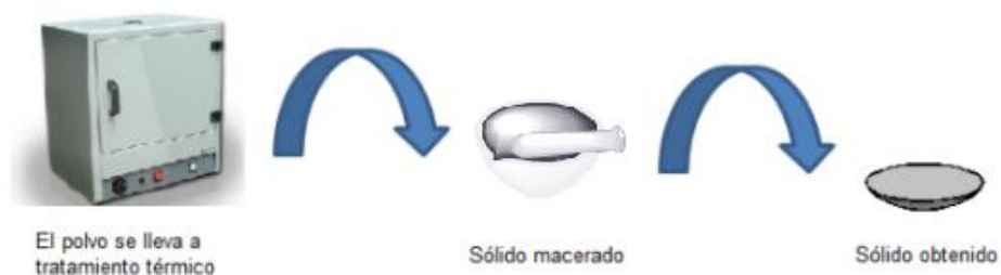
Figura 2.32. Etapas del tratamiento térmico a 300 °C a que fueron sometidos los sólidos obtenidos a diferentes pH para obtener el ZnO de interés.
