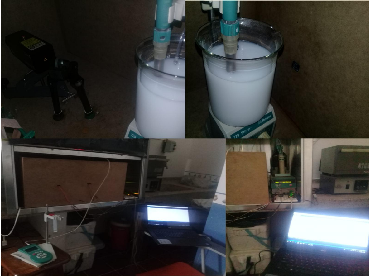
Figura 3.3 Fotografías del montaje óptico empleado para registrar los cambios “ópticos” del sistema solución/suspensión de cinc durante la formación de la fase sólida en su interior.
