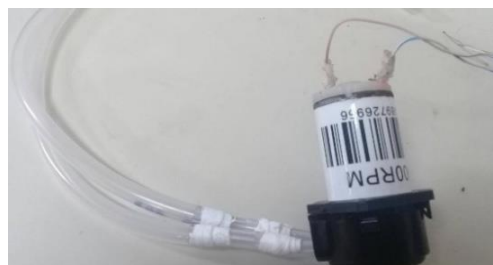
Figura 3.13. Bomba peristáltica usada en el primer prototipo.
