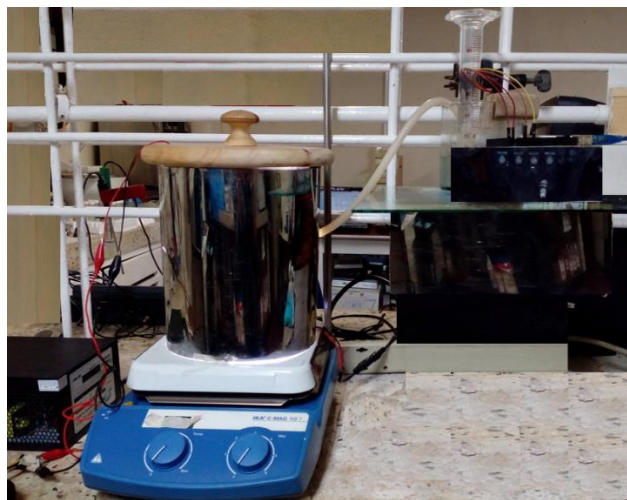
Figura 5.3. Reactor fotocatalítico AMP1 implementado.
