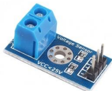
Figura 2.19 Sensor de voltaje FZ0430 de 0 - 25 voltios. (Fuente: propia)
