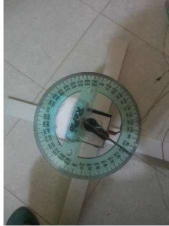
Figura 3.9 Caracterización del servo motor con ayuda de un transportador. (Fuente: propia)
