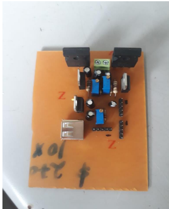
Figura 3.14 Regulador de tensión terminado en la placa de cobre. (Fuente: propia)
