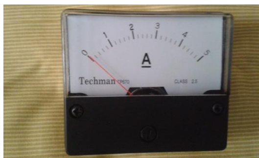
Figura 2.21 Amperímetro analógico de corriente directa de 0 a 5 Amperios. (Fuente: Propia)
