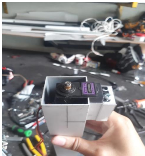
Figura 3.16 Fijación del motor para el ángulo azimutal. (Fuente: propia)
