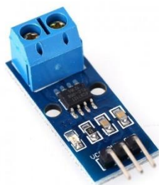
Figura 2.18 Sensor de corriente ACS712 de 5 amperios. (Fuente: propia)
