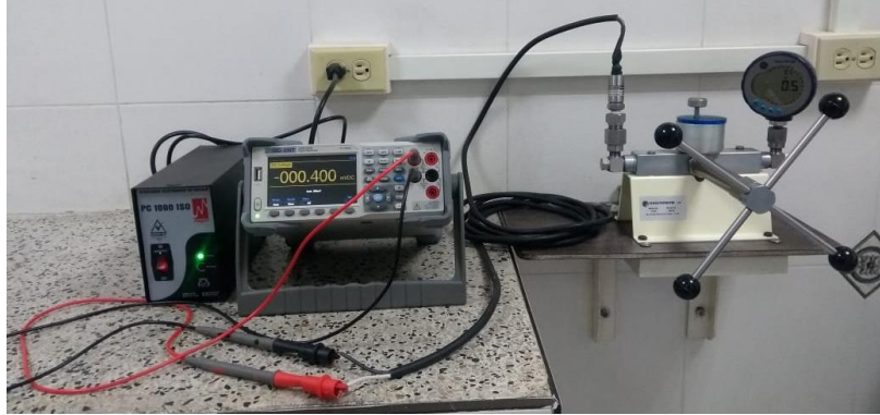
Figura 13. Montaje para la comprobación de los transmisores
