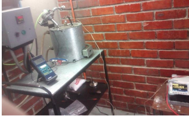
Figura 12. Montaje para la comprobación de las Pt-100.
