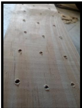
Ilustración 22 perforación para sistema de riego
