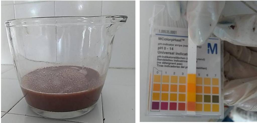
Imagen 38 medición de pH en el mosto.
