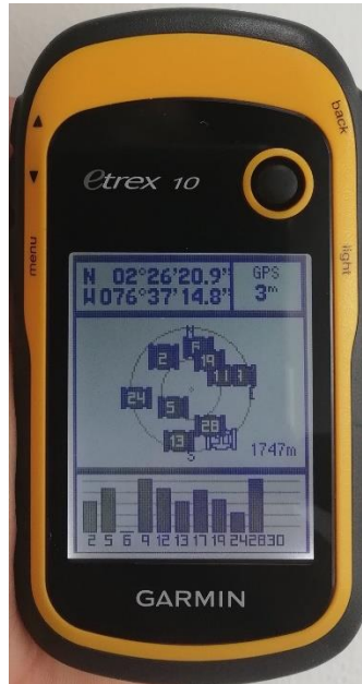
Imagen 13. Verificación de los satélites que capta el GPS. Fuente: elaboración propia.
