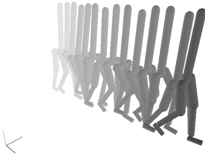
Figura 5.11: Simulación marcha de robot de 11 grados de libertad
