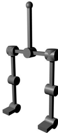
Figura 2.1: Esquema general del robot bípedo
