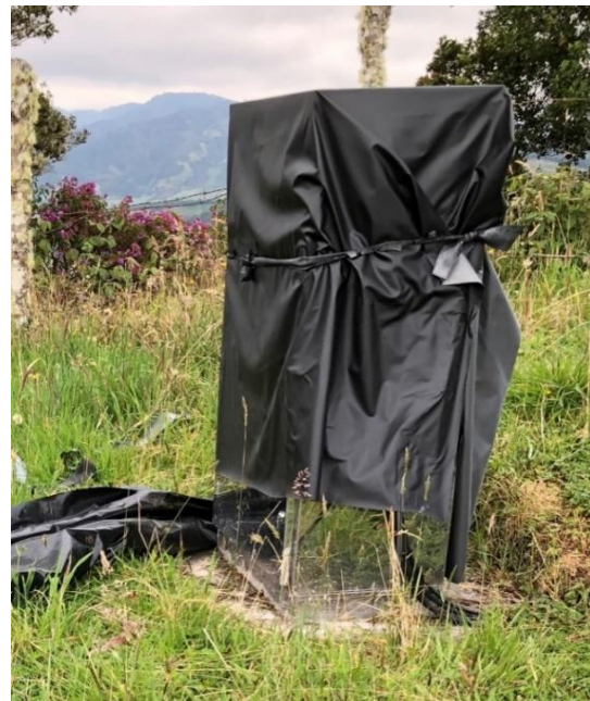
Figura 3.22. Sistema de protección de una estación en intemperie
