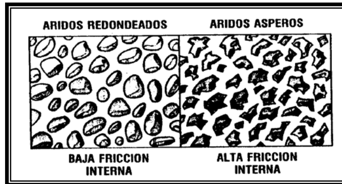
Figura 20. Forma de las partículas de agregados
