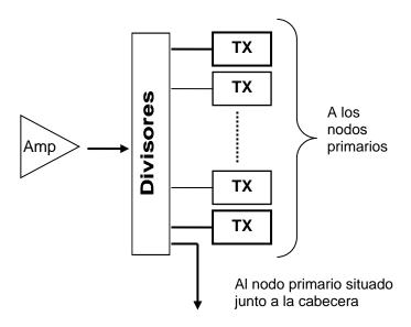
Figura 1.5. Sistema de Transmisión Optico de la Cabecera
