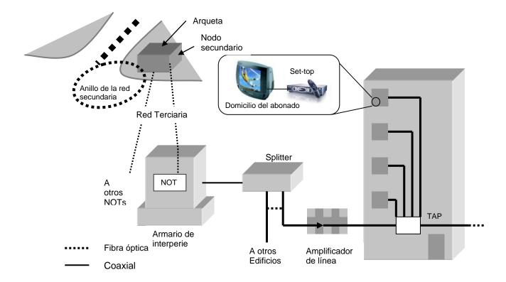
Figura 1.12. Conexión del Set-top de Abonado a la Red
