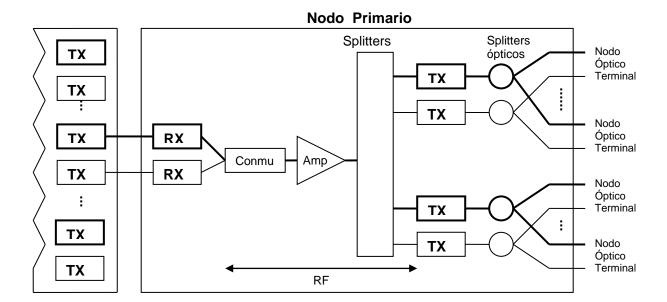
Figura 1.7. Canal Descendente de un Nodo Primario
