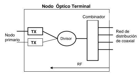
Figura 1.11. Canal Ascendente de un Canal Optico Terminal
