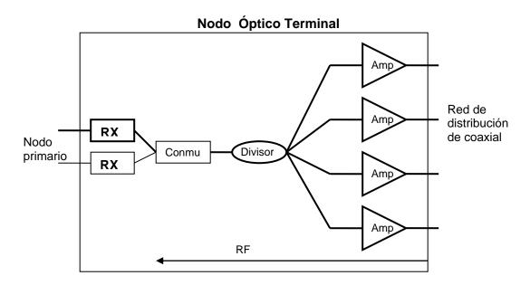
Figura 1.10. Canal Descendente de un NOT
