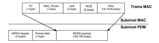
Figura 1.15. Trama del Canal Descendente
