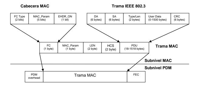
Figura 1.14. Trama del Canal Ascendente.
