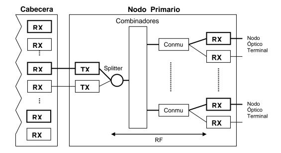
Figura 1.8. Canal Ascendente de un Nodo Primario
