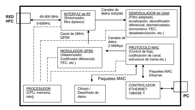
Figura 2.1. Diagrama de Bloques de un Cable Módems Bidireccional
