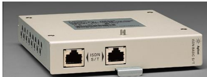
Figura 1.12. Módulo de Interfaz J2904B ISDN BRI S/T.
