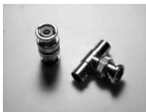
Figura 21. Conector BNC T.
