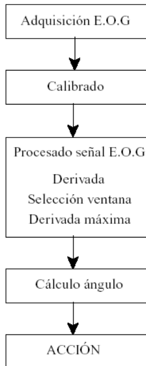
Figura A.26. Diagrama de flujo del procesamiento de la señal EOG.[3]
