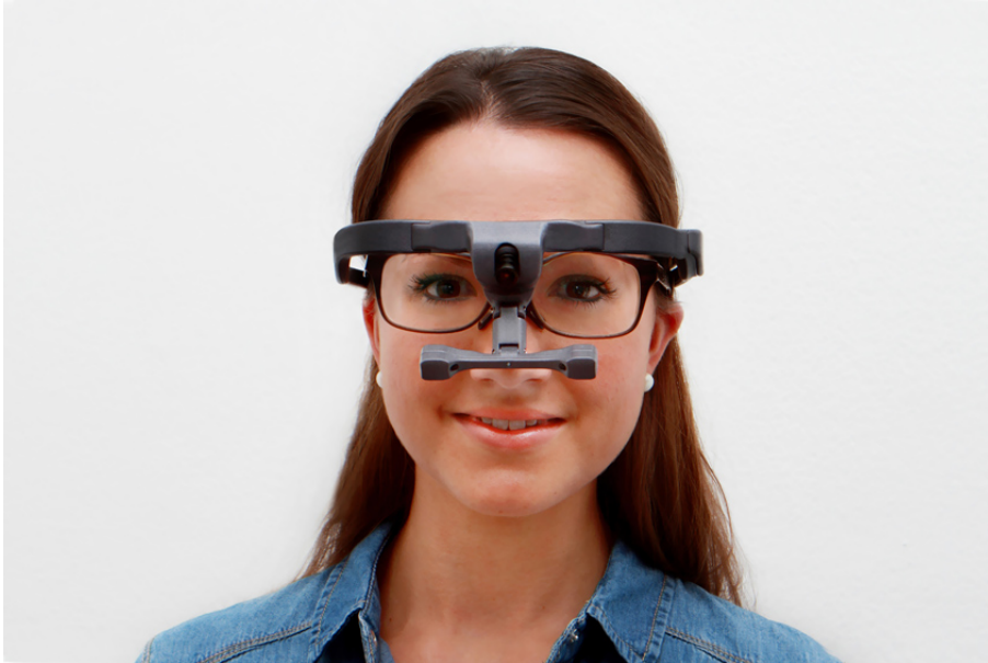
Figura 3.7: Dispositivo de vídeo-oculografía montado, por Ergoneers [7]
