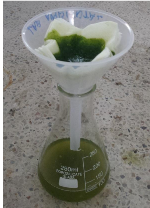
Figura 3. Filtración del jugo de Fique utilizando ocho (8) capas de gasa quirúrgica.
