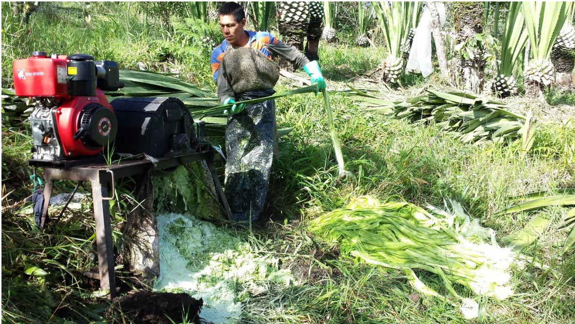
Figura 1. Obtención de la fibra de Fique y bagazo como residuo del proceso, por medio de una maquina desfibadora.
