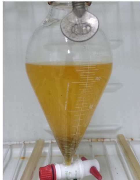
Figura 5. Fermentación del jugo de Fique filtrado en embudo de separación (Día 2)
