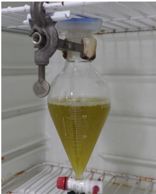
Figura 4. Fermentación del jugo de Fique filtrado en embudo de separación (Día 0)
