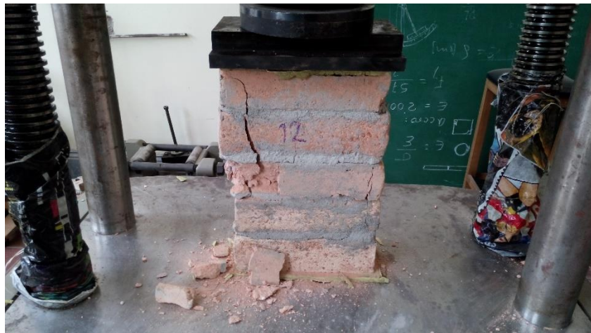
Foto 40. Falla a compresión de prisma 12
