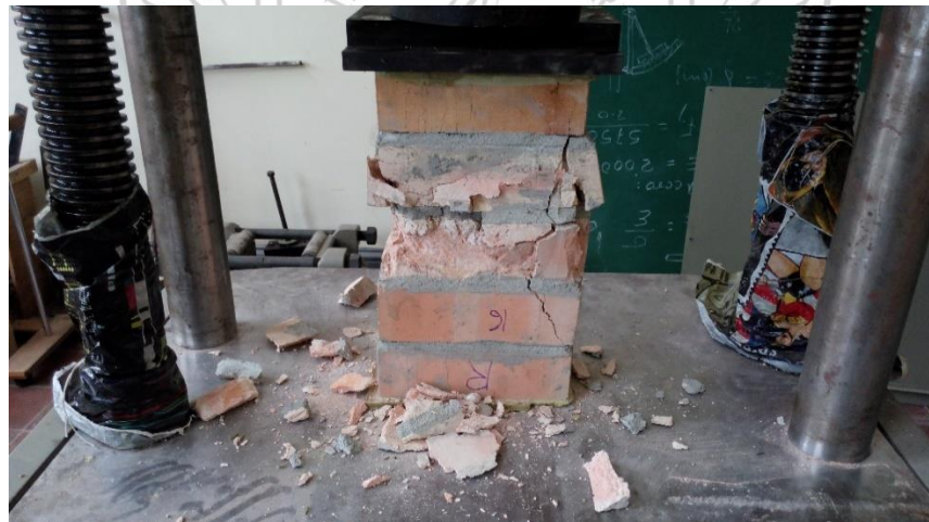
Foto 44. Falla a compresión de prisma 16
