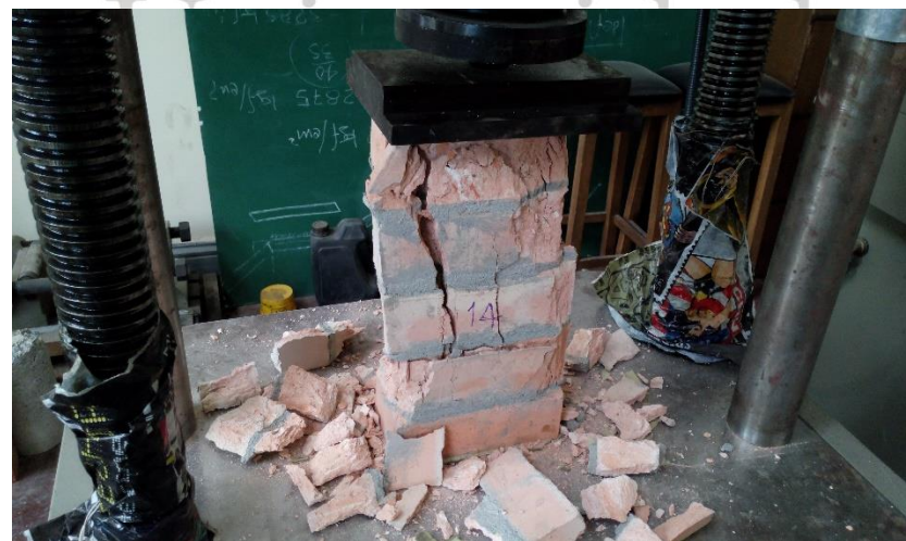
Foto 42. Falla a compresión de prisma 14
