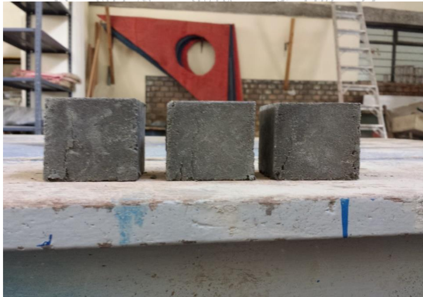
Foto 13. Falla de los cubos mezcla 2.
