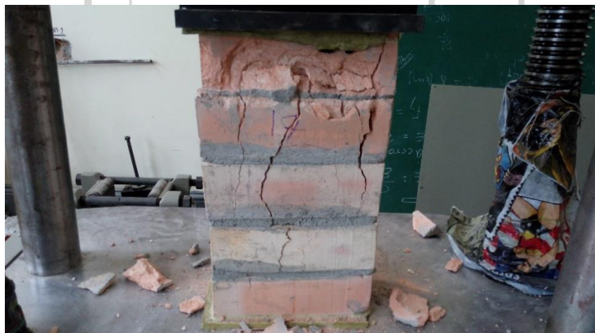
Foto 45. Falla a compresión de prisma 17
