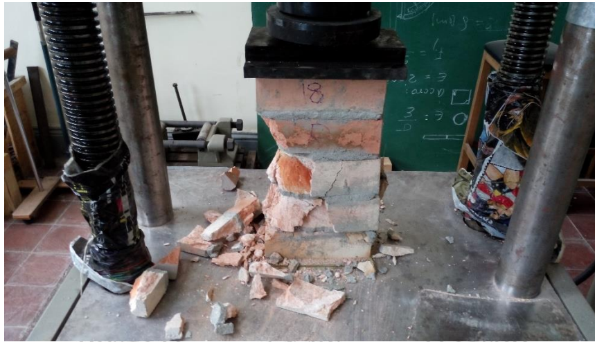
Foto 46. Falla a compresión de prisma 18
