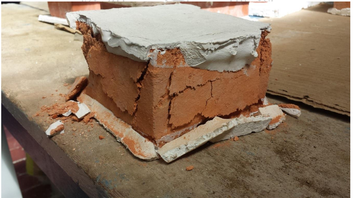
Foto 26. Falla unidad de mampostería refrentada con yeso.
