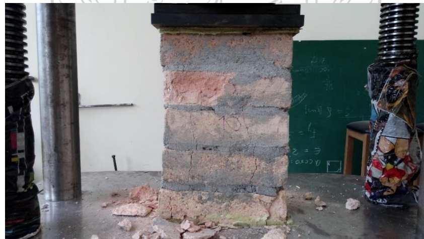
Foto 38. Falla a compresión de prisma 10
