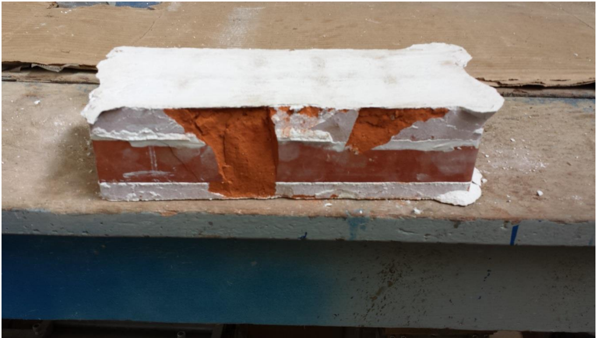
Foto 27. Falla del ladrillo que se produce de manera industrial refrentado con yeso.
