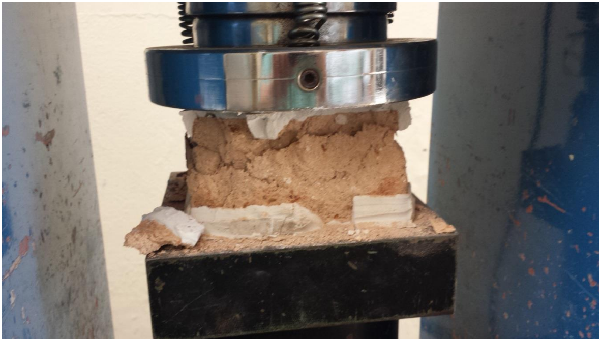
Foto 25. Falla unidad de mampostería refrentada con yeso.
