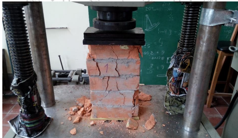
Foto 29. Falla a compresión de prisma 1
