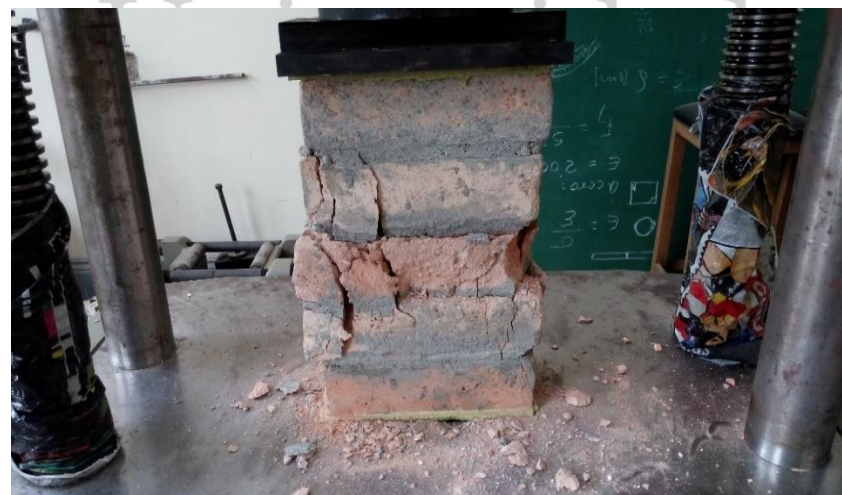
Foto 39. Falla a compresión de prisma 11
