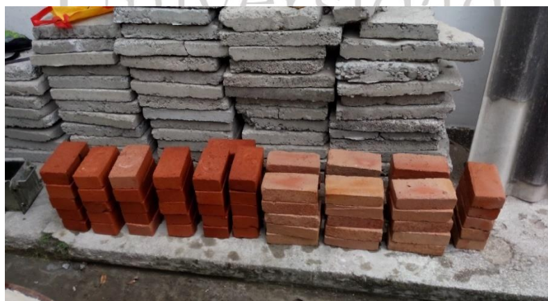
Foto 17. Ladrillos después de humedecerlos.
