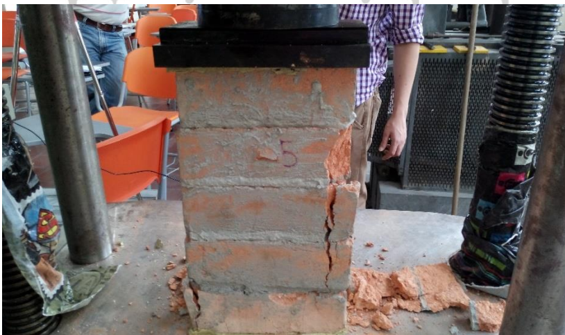
Foto 33. Falla a compresión de prisma 5
