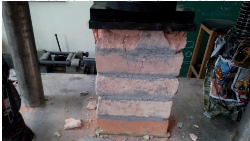
Foto 35. Falla a compresión de prisma 7
