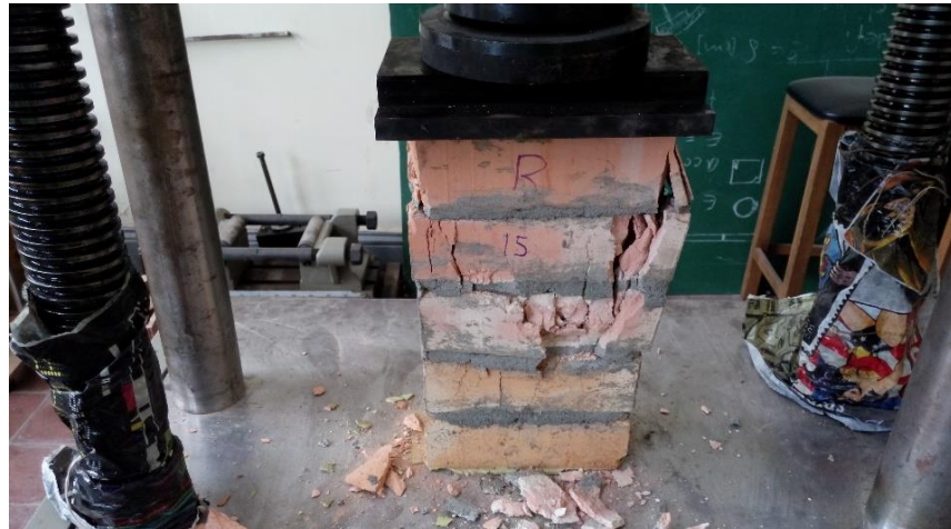
Foto 43. Falla a compresión de prisma 15
