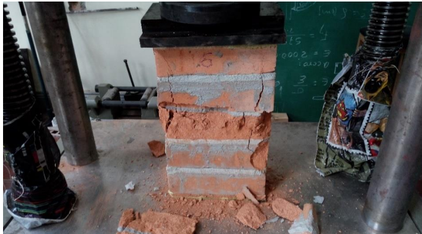
Foto 34. Falla a compresión de prisma 6
