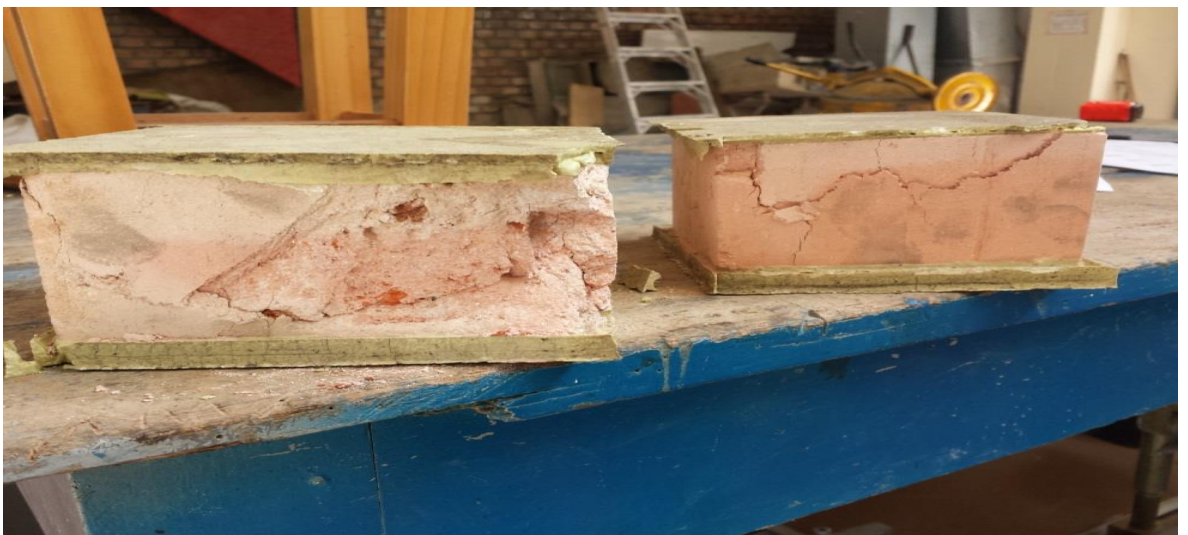
Foto 6. Falla de las unidades de mampostería.
