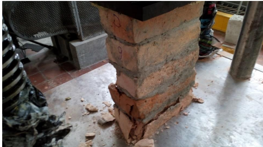
Foto 37. Falla a compresión de prisma 9
