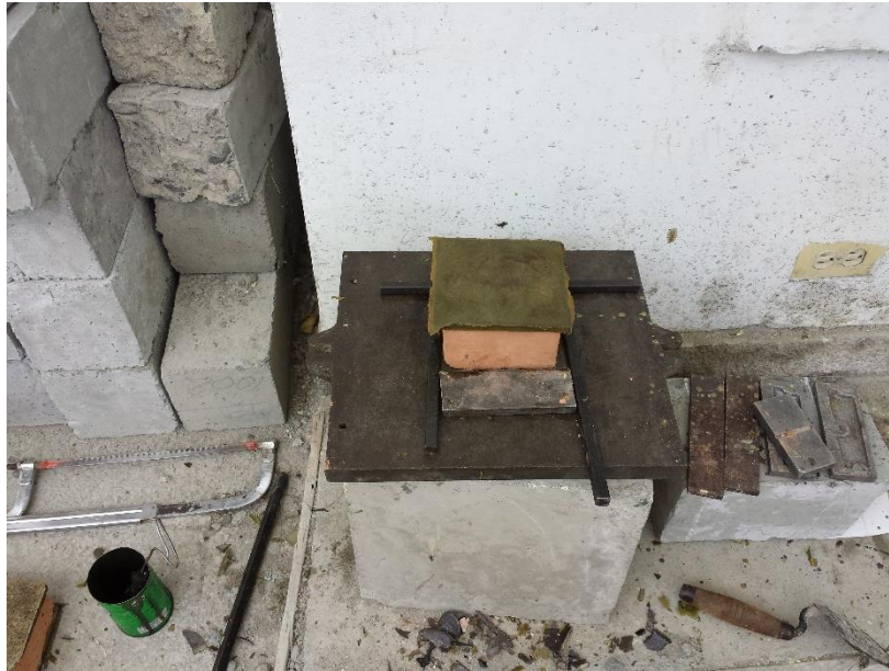
Foto 22. Unidad de ladrillo refrentada con azufre.
