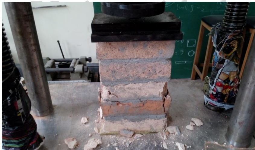
Foto 36. Falla a compresión de prisma 8
