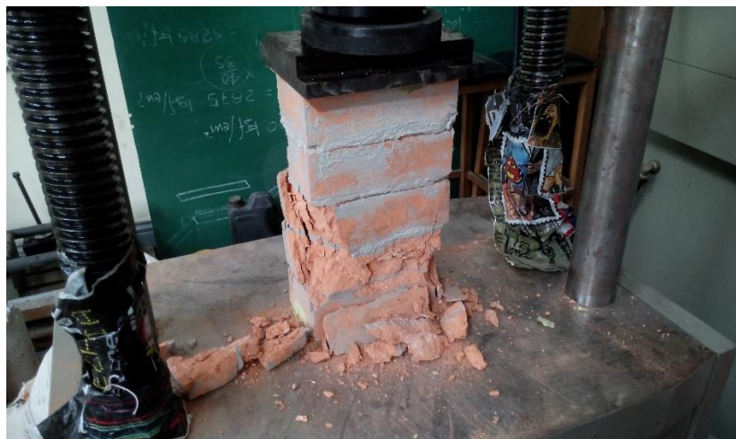
Foto 30. Falla a compresión de prisma 2
