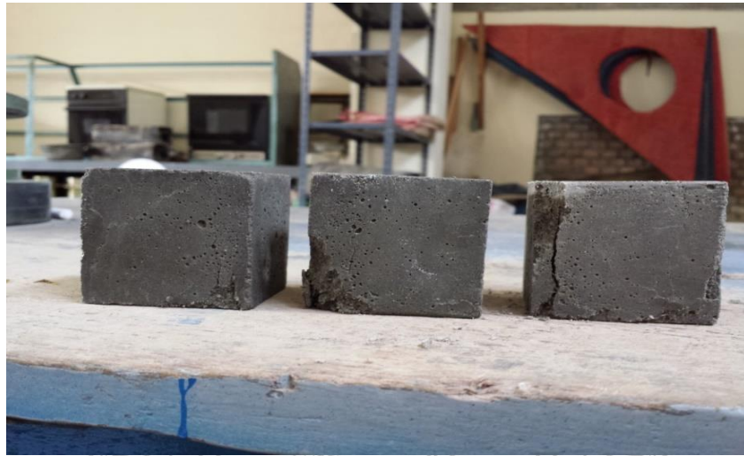
Foto 12. Falla de los cubos mezcla 1.
