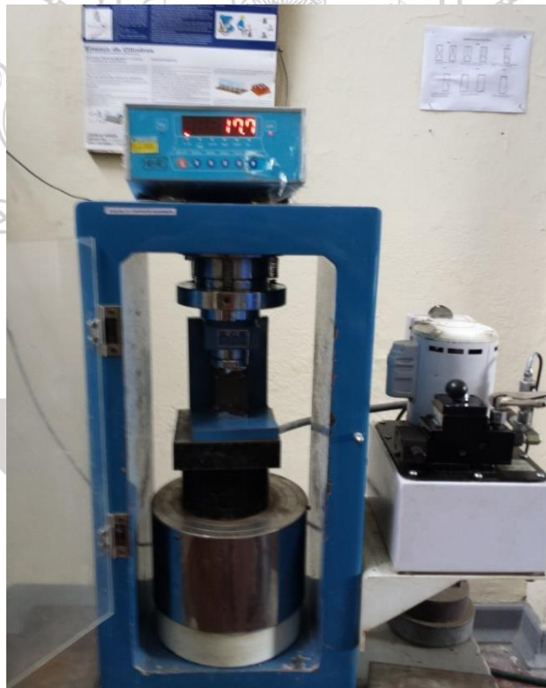
Foto 11. Ensayo de compresión sobre cubos de mortero.
