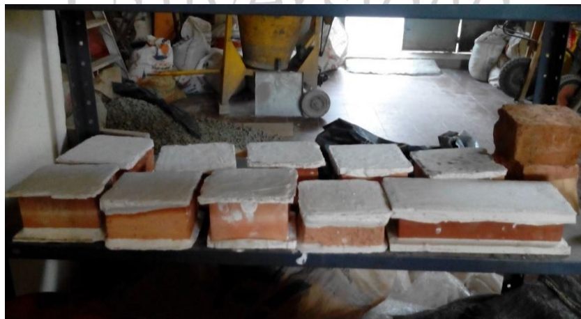
Foto 23. Refrentado de unidades de mampostería con yeso.
