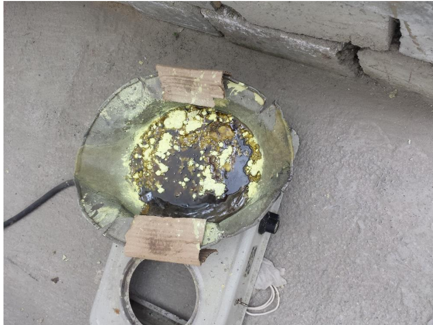
Foto 21. Proceso de calentamiento del azufre.
