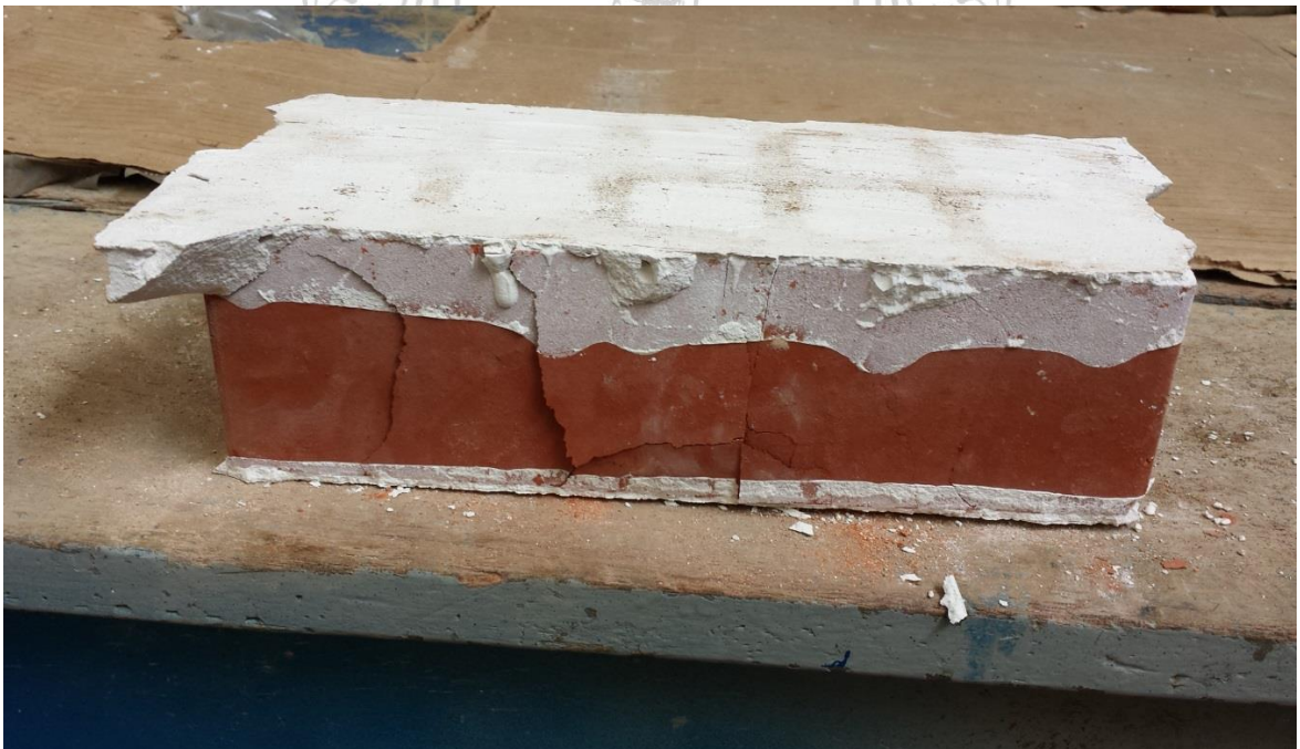
Foto 28. Falla del ladrillo que se produce de manera industrial refrentado con yeso.
