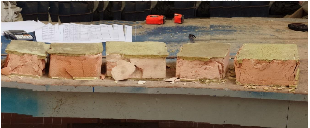
Foto 5. Falla de las unidades de mampostería.
