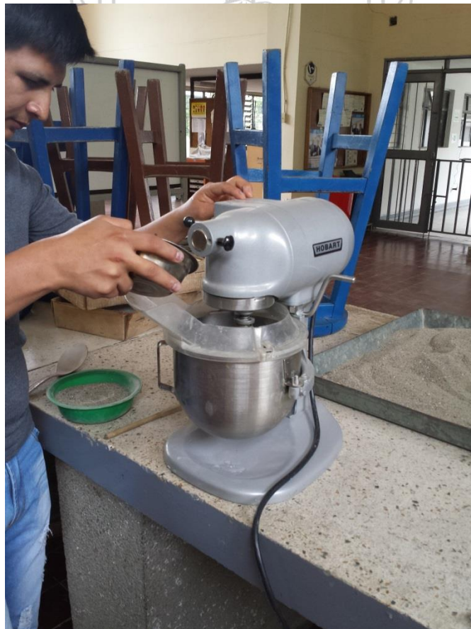
Foto 9. Mezcla mecánica de mortero.
