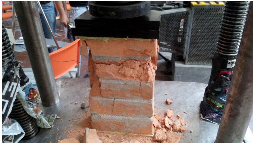
Foto 31. Falla a compresión de prisma 3
