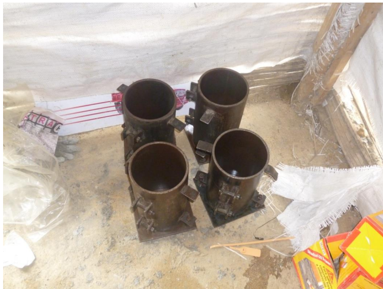
Figura No 31 Moldes para la realización de especímenes de concreto
