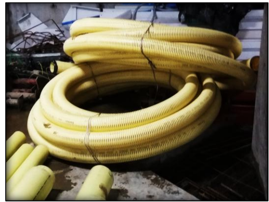
Tubería perforada 4" (Filtros)
