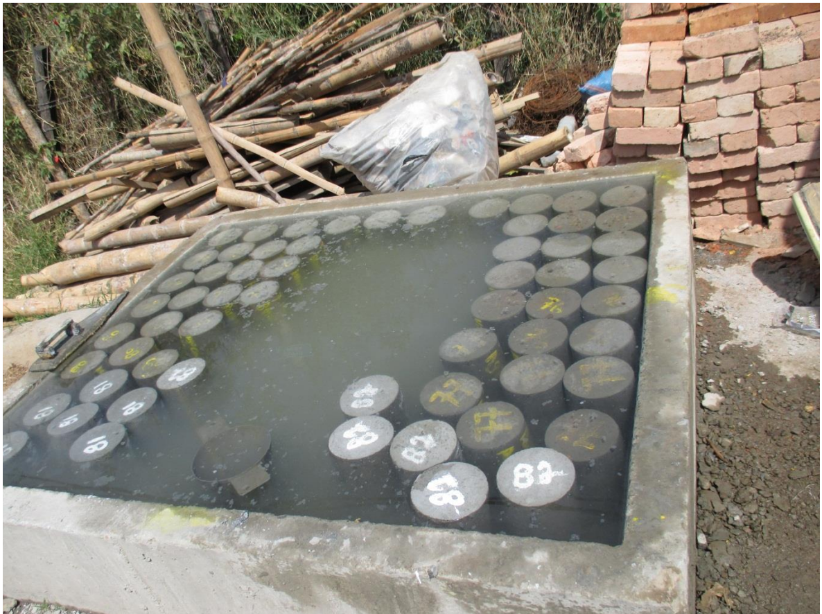
Figura N° 12. Piscina para el curado de especímenes de concreto (Fuente: propia).
