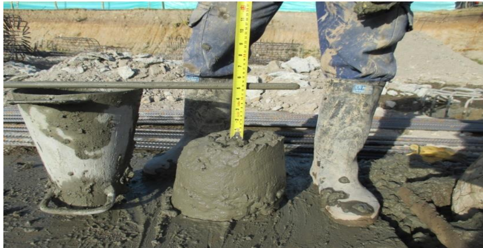
Figura N° 11. Medición del asentamiento del concreto mediante la prueba del slump (Fuente: propia).
