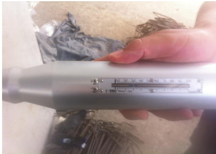
Figura N° 14. Prueba de Resistencia con el ensayo del martillo esclerométrico (Fuente: propia).
