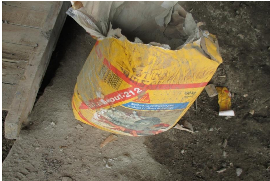
Figura N° 50. Saco de sika grout usado para fundir la base de la columna metálica (Fuente: Interventoría).
