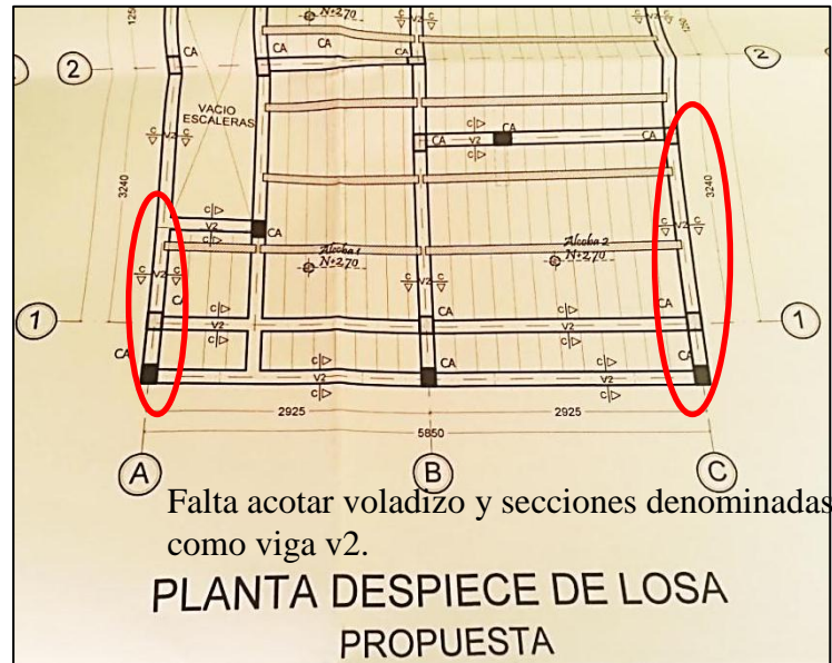
FIGURA N° 25. Errores planta de la losa propuesta.
