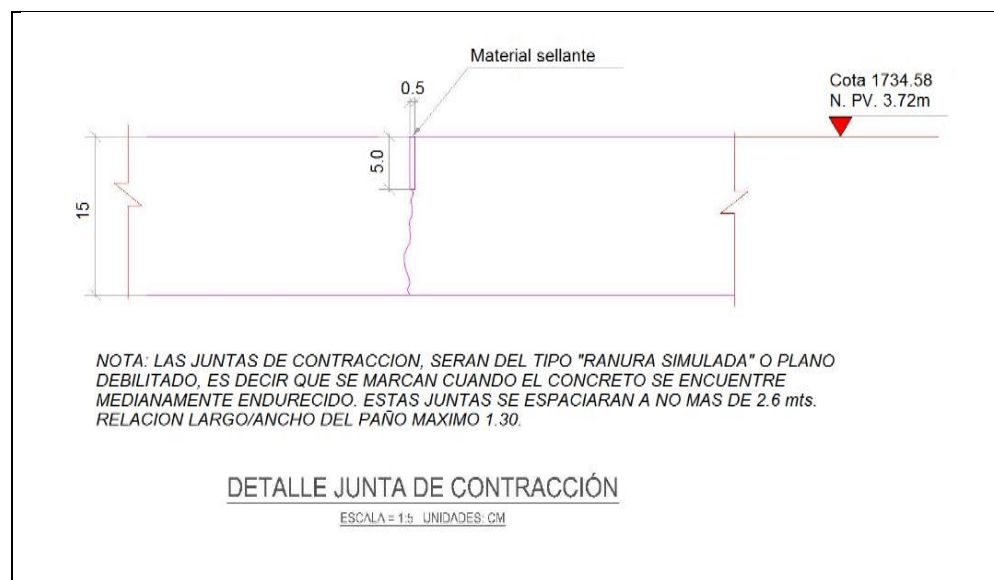
Fig. N°71. Detalle junta de contracción.
