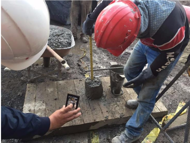
Fig. N°79. Ensayo de asentamiento.
