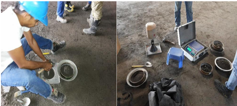
Fig. N°67. Toma de densidades con cono de arena.
