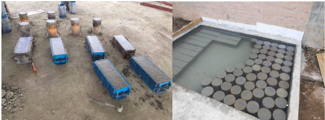
Fig. N°78. Muestras para ensayo de resistencia a la flexión y curado en cal de especímenes de muestra.
