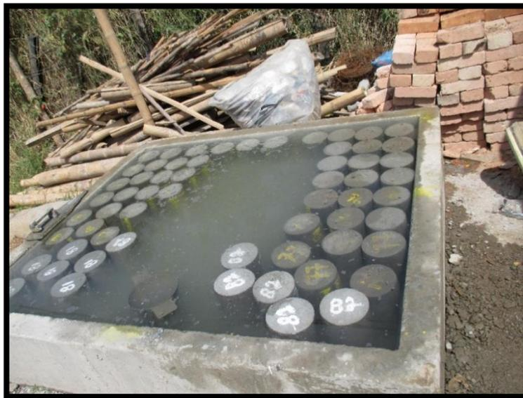
*Figura 78. Tanque para curado de muestras.
