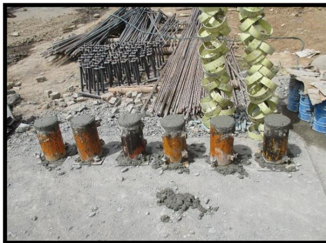
*Figura 76. Muestras para resistencia. (Fuente: Propia)*
