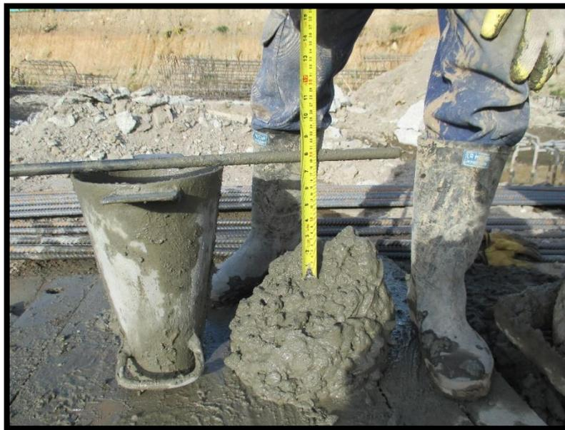
*Figura 77. Prueba de Slump. (Fuente: Propia)*
