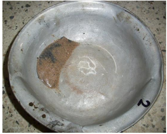
Lavado de la muestra por el tamiz No 200.
