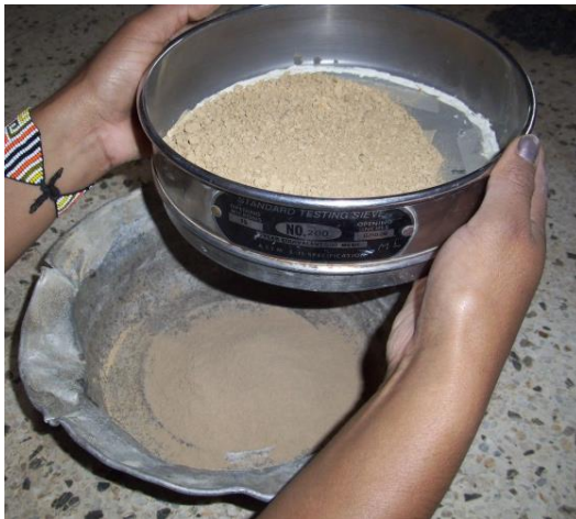
Obtención de las fracciones de suelo entre cada abertura de tamiz.
