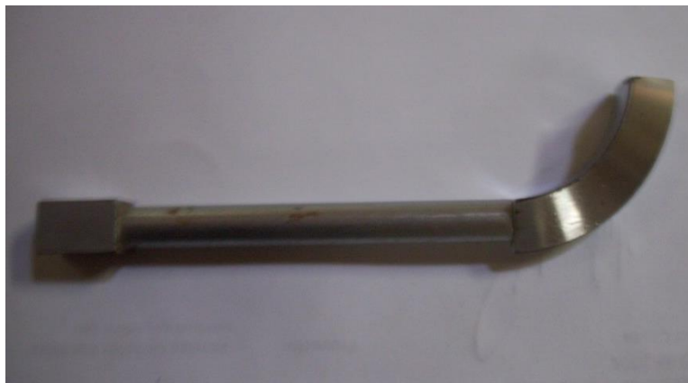
Figura 23. Medidas, esquema y fotografía del ranurador curvo para el método de Casagrande. (AASHTO, 2013).
