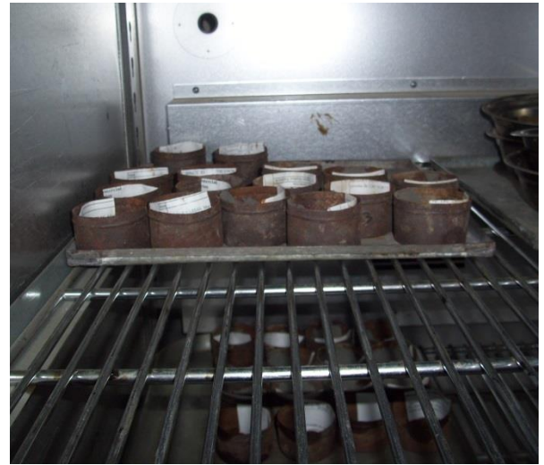
Introducción de los testigos de humedad en el horno durante el tiempo necesario para obtener masa constante.
