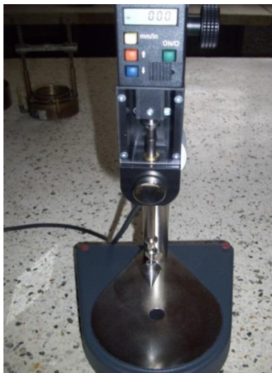
Equipo de penetración con el cono de 30 grados.
