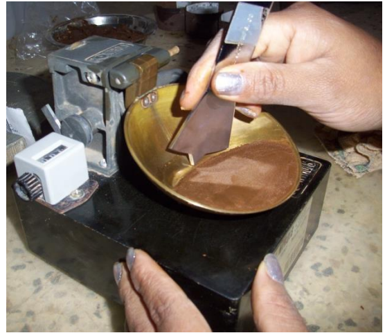
Ranuración a lo largo de la muestra. En figura el ranurador plano.
