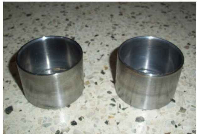
Copas para la colocación del suelo a penetrar
