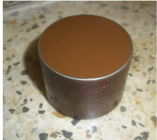
Disposición de la muestra en la copa antes de proceder a la penetración.
