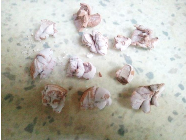
Figura 57. Descripción típica de las muestras con Kerosene y Salmuera luego de ser secadas al horno en el ensayo del límite líquido.
