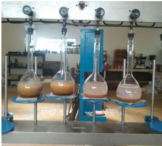
Extracción de los vacíos con aire de cada lecha en la bomba de vacíos.
