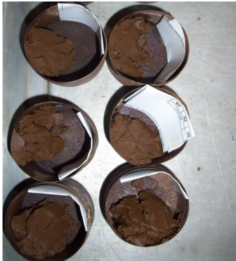
Toma de los testigos de humedad con su correspondiente referencia.
